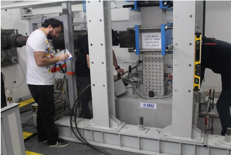
Şekil 3.3: Deney numunesinin yüklemesi sırasında yapılan ses ölçümü fotoğrafları
